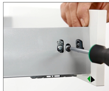
3. Регулиране на челото L/R ( \pm 1,5 мм)
